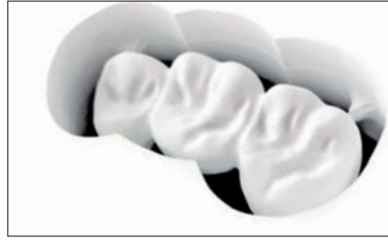
الشكل ٦: جسر أكسيد الزركون بعد التفرزيز بالأسطوانة والتركيز على تشكيل السطح الطاحن.
