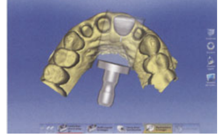
الشكل ٩: بعد تصميم التيجان يجري تفريزها من كتل lithium disilicate glass ceramic (IPS e.max CAD HT C14/A2).
